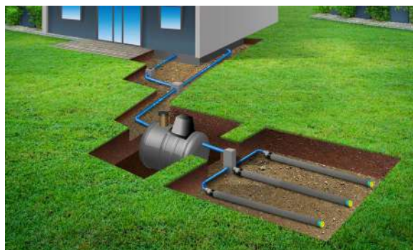
infiltration des eaux claires après système de traitement agréé.
