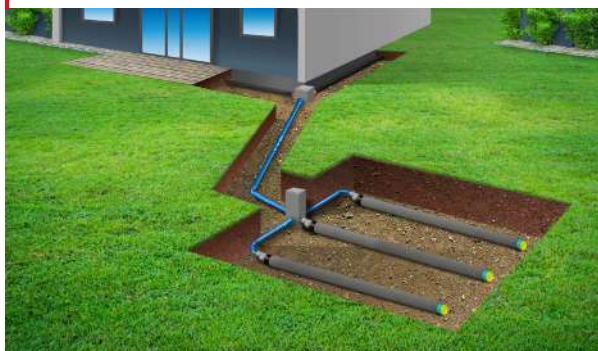
infiltration des eaux de pluie
