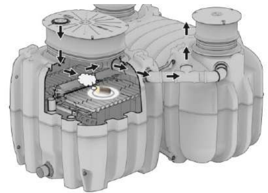
Fig. 43: Test de fumée
