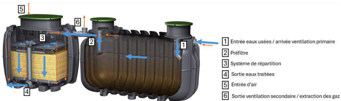
Fig. 50: Circulation de l'eau – Points de contrôle (flux hydraulique en bleu et flux d'air en orange)
