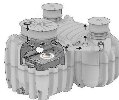
Fig. 62: Test de fumée
