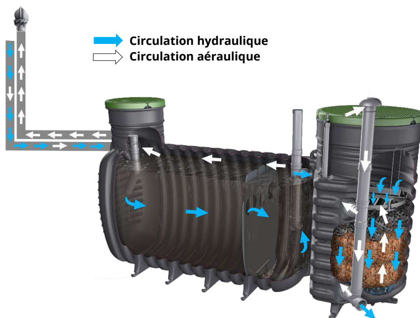
Schéma de la circulation d'eau et de la ventilation
