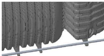
Principe d'ancrage de la easyCompact 4EH
