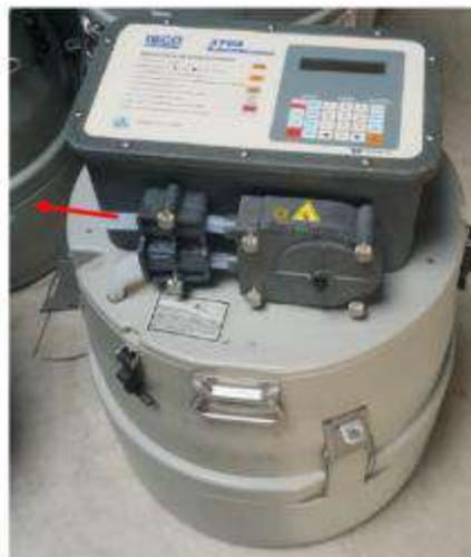
5. Scotcher le tuyau d'aspiration au guide PVC afin de la maintenir en place même lorsque le tuyau sera vide après la phase de purge.
